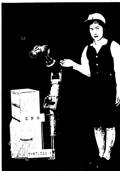
図4 7自由度マニピュレータ 開発した7自由度マニピュレータの写真。 7 degree of freedom manipulator
