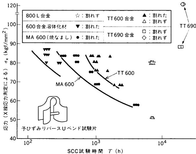
図2 伝熱管材料の360℃温度加速PWR一次系模擬水中耐SCC性
