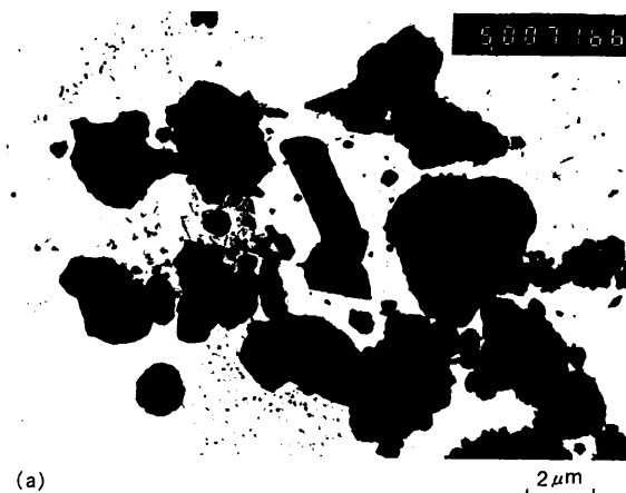
図4 (a)TEM写真と(b)30h粉砕後のEDSスペクトル分析結果 分析ではBi, Sb, Teが検出されている。 (a) Transmission electron micrograph, and (b) energy dispersive spectroscopy profile of BiSbTe after 30 h milling
