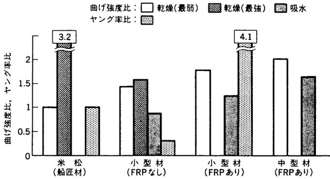
図7 人工木材試作材 強度評価結果 米松(船匠材)の最弱方向に比較し、人工木材が強度異方性小・吸水強度減少の特性を持つことが分かった。
