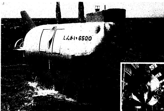
図6 “しんかい 6500”とチタン合金製耐圧殻 “しんかい 6500”の外観と電子ビーム溶接されたチタン合金製耐圧殻。
