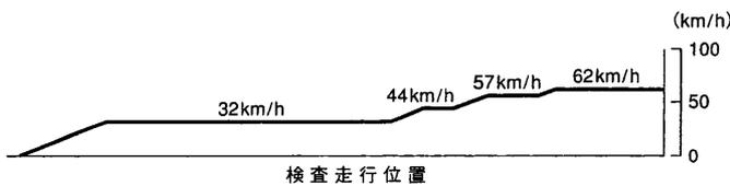
図2 速度指令出力例 自動運転の速度データに基づく速度パターンの一例を示す。
