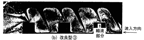
図3 可視化試験結果 クリアランスが小さい (クリアランス比1.0) とときの現状型と改良型③の可視化試験結果を示す。 Flow visualization result of labyrinth seal in case of small clearance
