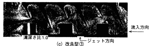
図4 可視化試験結果 クリアランスが大きい (クリアランス比3.0) とときの現状型と改良型①、③の可視化試験結果を示す。 Flow visualization result of labyrinth seal in case of large clearance
