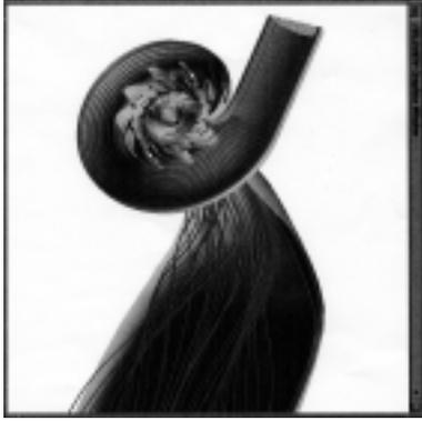
近年、水車既設機の改修による効率向上や出力増大のニーズが高まっており、従来と同等の寸法の下で要求性能を満たす設計技術が要求されている。このため、CFD技術の急速な発展を背景に、既存模型試験データを有効活用して、CFD解析から得られた予測を補完・高精度化するハイブリッド性能予測手法を創出し、短期間・低コストで最適化設計を行う技術を構築した。本報では、実機ランナ取替え工事に伴い、ランナの最適設計を実施、ハイブリッド性能予測手法を用いて新設ランナの水車性能を予測、現地効率試験により性能改善及び予測値との良好な一致を確認した結果を紹介する。
