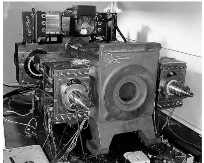
図7 ボールねじ耐久要素試験機 実機サイズのベアハウの両側に市販最大径サイズ直径φ140 mm ボールねじを配置した要素試験機で、ボールねじ耐久性を評価した。
