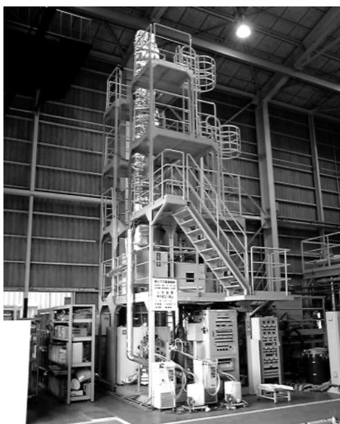
図4 連続分解試験装置 ラボ試験用分解装置の外観を示す。
