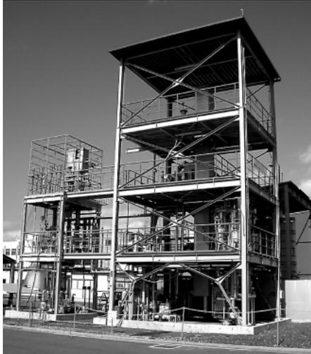
平成9年の容器包装リサイクル法施行以来、使用済みPETボトルを繊維やシート等へ変換するリサイクルが行われている。一方、この使用済みPETボトルをその原料となるモノマへ再生し再度飲料用ボトルへリサイクルするケミカルリサイクルが、“循環型社会”に最も適している技術としてニーズが高まっている。弊社では、超臨界メタノールを用いPETを短時間で分解しモノマに戻すケミカルリサイクルプロセスの開発を行っている。弊社開発プロセスの適用により石油から製造した原料モノマと同等な品質を有するモノマが使用済みPETボトルから回収できることを確認した。また、FS (Feasibility Study) の結果、経済性が成立することも確認した。
