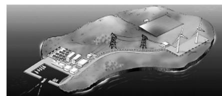
図10 離島用太陽光・風力発電システム設置イメージ ディーゼル発電の代替として離島に太陽光発電と風力発電を設置した場合のイメージ図を示す。
