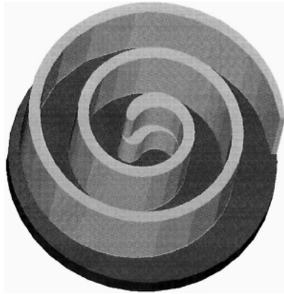
図10 新スクロールプロファイル (段付きプロファイル)
