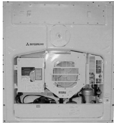
図13 海上レフユニット外観
