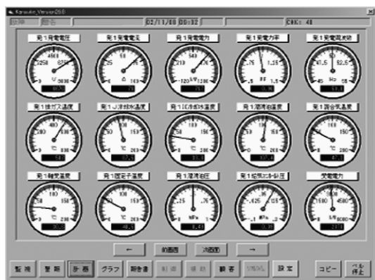
図2 監視画面サンプル(1) 稼働状況のデータのメータ表示状態。
