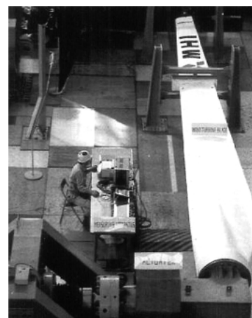
図7 29.5 m翼の疲労試験
