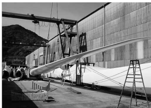
図16 2000kW用36m翼の最大荷重試験
