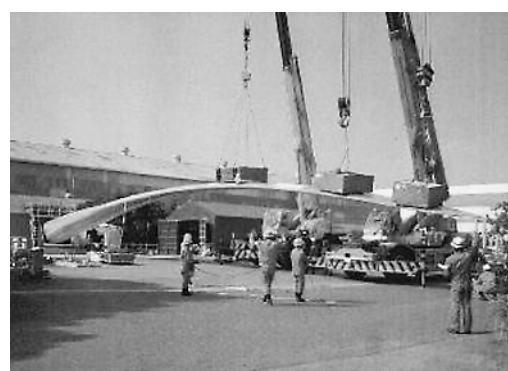
図6 29.5 m翼の最大荷重試験
