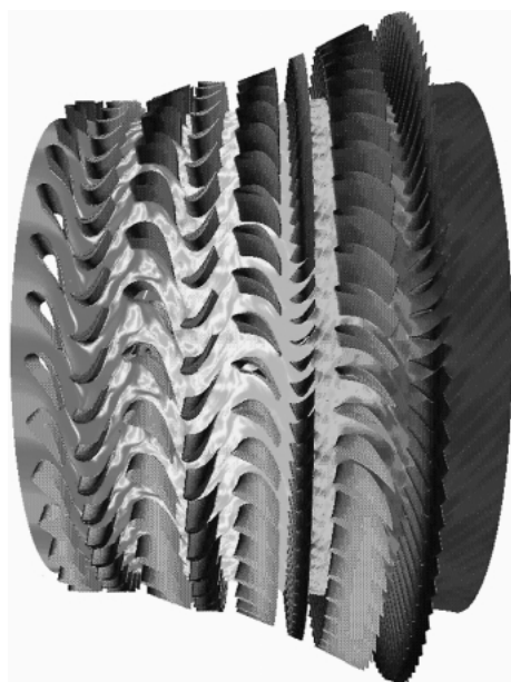
図3 非定常流れ解析によるタービン翼列内部ガス温度分布
