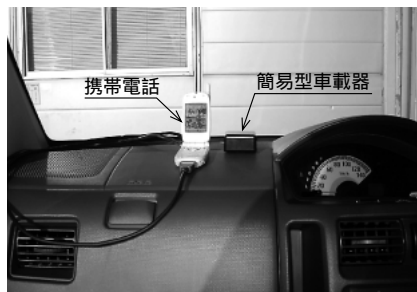
図7 車載器及び携帯電話設置例 実際の車両に車載器及び携帯電話を設置した状態の一例。
