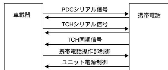
図3 車載器-携帯電話インターフェース概要 車載器と携帯電話間のデータのやり取りを図示。
