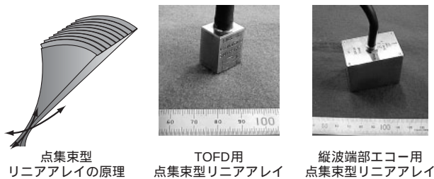
図4 点集束型リニアアレイの原理とプローブ概観
