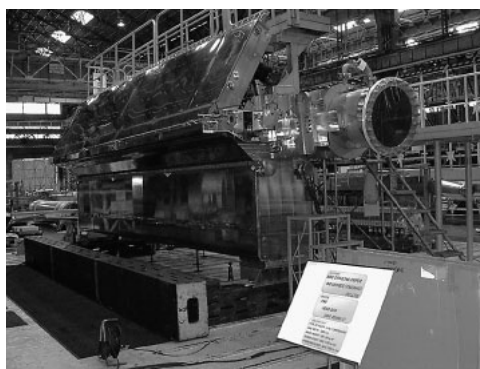
図1 MJヘッドボックス 所内組立外観．
