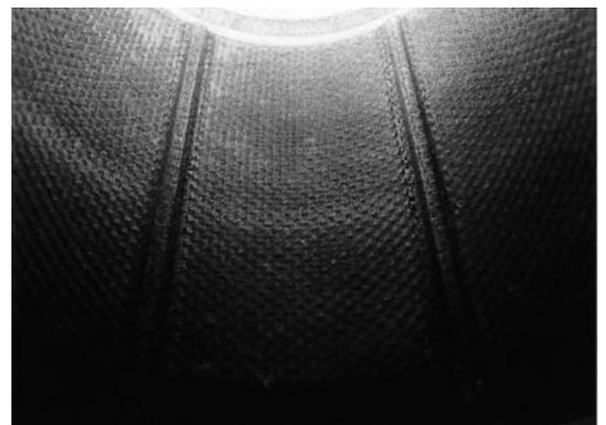
図3 試験後の軸受摺動面状況
