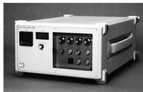
図2 ガスモニタリング装置の測定ユニットの外観
