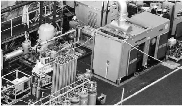
炭鉱での石炭採掘時に発生する炭鉱メタンガスは、その大部分が未利用のまま大気放出され、地球温暖化の一因となっている。炭鉱メタンガスは低メタン濃度かつ濃度変動が大きいいため、これまで有効利用は困難であった。本技術開発では、マイクロパイロット着火技術を利用した希薄燃焼ガスエンジンをベースに、炭鉱メタンガスを燃料として高効率発電が可能なガスエンジンを開発し、温室効果ガス排出量の低減を図る。これまでに、試験装置を用いて炭鉱メタンガスの燃焼特性を把握したほか、炭鉱メタンガスに適したガス供給方式の検討を行った。
