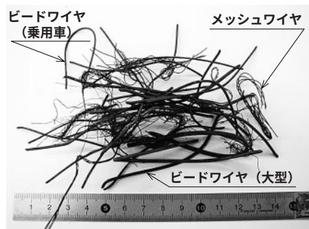
図6 排出ワイヤ外観 メッシュワイヤは一部粉化されずに排出され、ビードワイヤは全て粉化されずに曲った状態で排出される。
