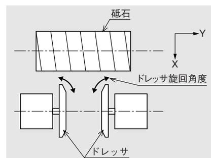
図5 従来の圧力角修整方法
