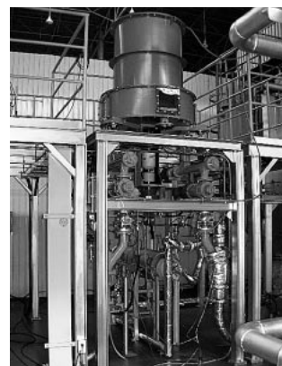
図3 バイオマス連続計量供給試験装置 計量払出からインジェクタで搬送する。
