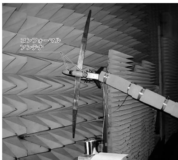
図5 電波情報収集センサ 電波特性取得試験
