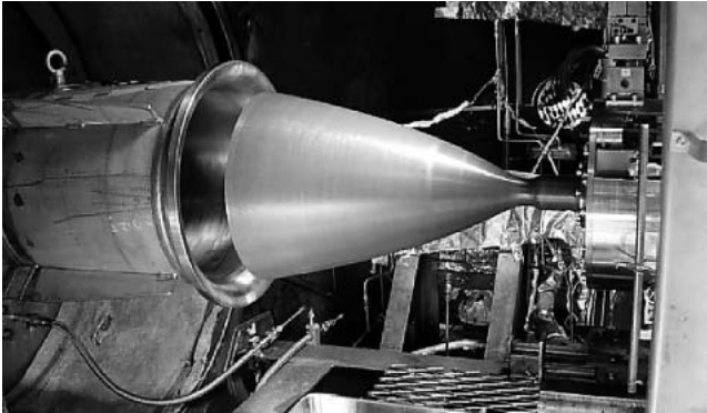
図7 燃焼試験セットアップ状況 低圧チャンパ室内にセットアップされた500Nセラミックススラスタ．
