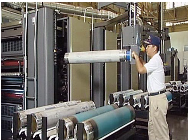
図2 スリーブ交換作業
