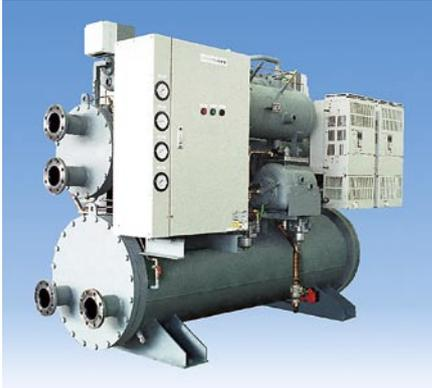
年間を通じて温度、湿度を一定に維持する必要がある工場の空調・冷水製造設備に対して、マイクロターボ冷凍機の導入を含む、省エネ改修工事を行った。マイクロターボ冷凍機は部分負荷運転時及び中間期、冬期の低冷却水時にインバータによる主電動機の回転数制御を利用することで消費電力を大幅に削減できる。当社は、本工事の計画から設計、施工、試運転まで一括して受注し、冷凍機の更新以外にも、外気冷房制御や隣接する他棟の冷凍機設備との冷水の共有化等の施策を実施し、年間を通じて大幅な省エネルギーの実績を得た。
