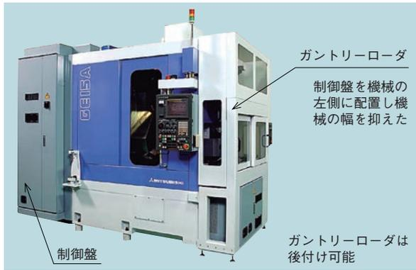
図7 GE15Aの外観図(ライン化対応機)
