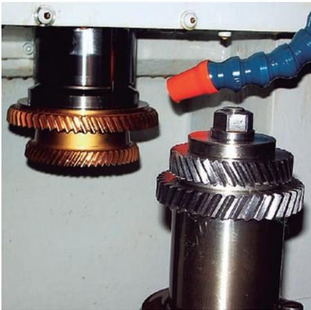
図 20 2段ギヤ加工
