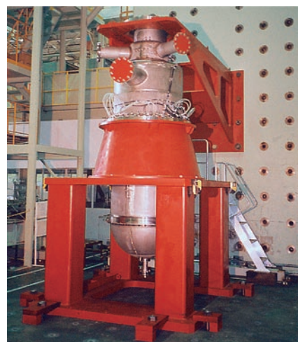
図 5 ポンプ組込型 IHX 振動試験装置
