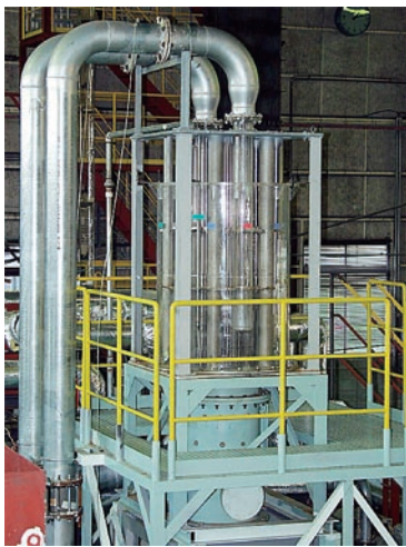
図 3 原子炉容器ガス巻込み試験装置
