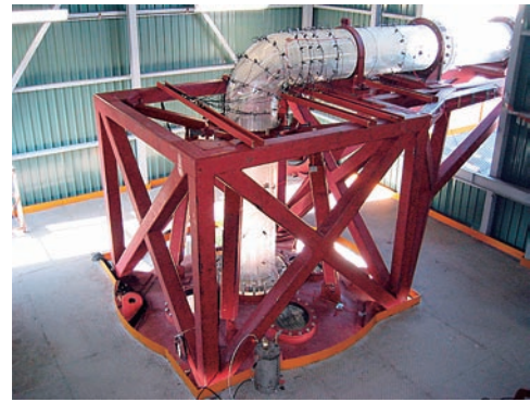
図 4 大口径 1 次系配管流動試験装置
