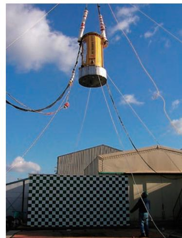
図10 1/2.35落下試験体による9m落下試験
