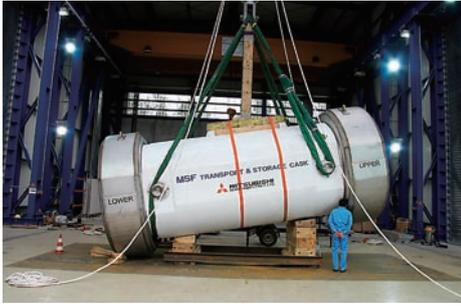
図 11 1/1 スケール落下試験体
