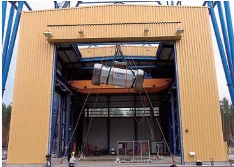
図 12 1/1 スケール 9m 落下試験
