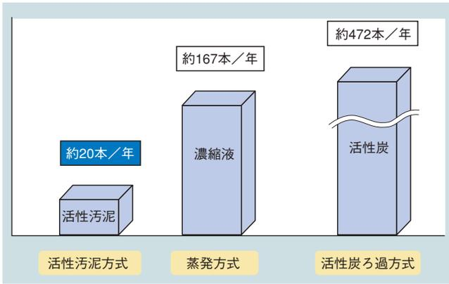
図6 二次廃棄物量の比較 (ドラム缶換算)
