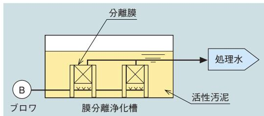
図3 膜分離活性汚泥法フロー図
