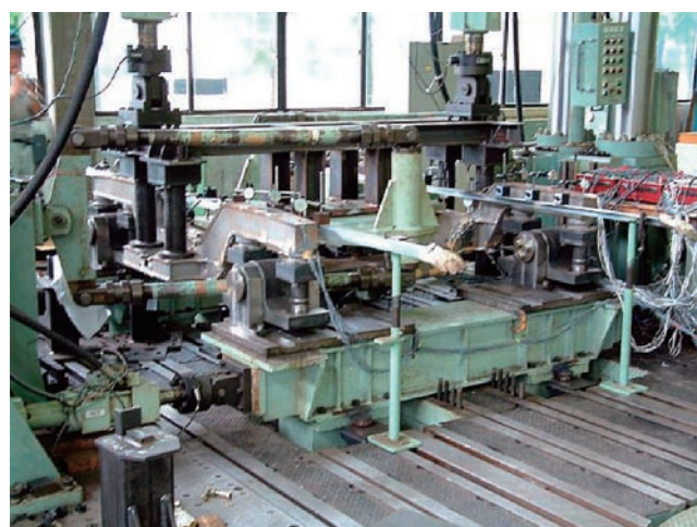
図4 従台車枠の静荷重試験
