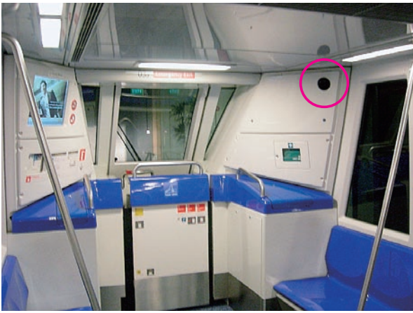
図 11 車上 CCTV カメラ
