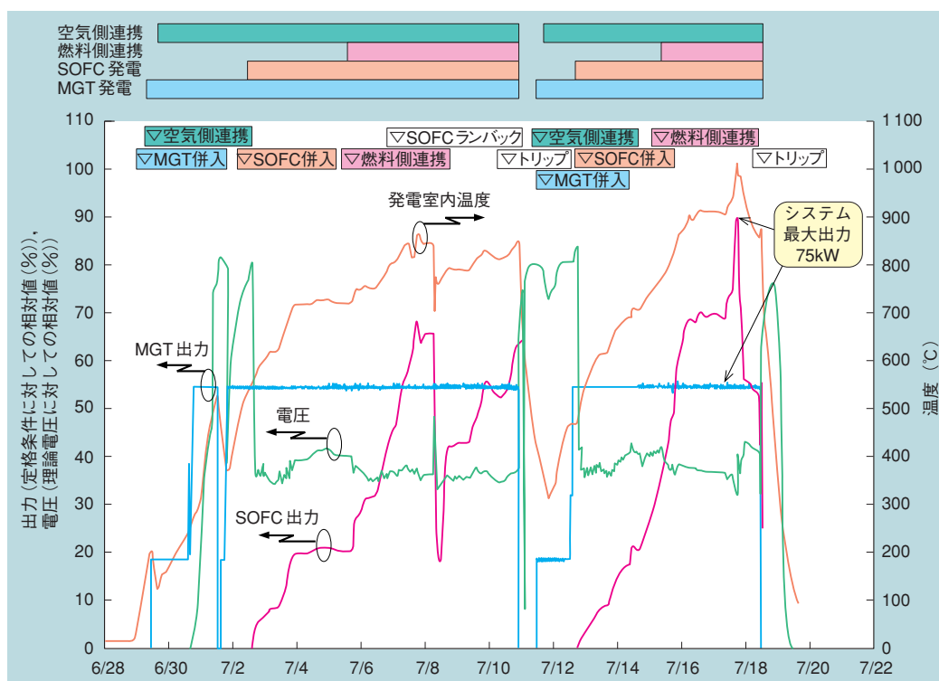
図 5 SOFC-MGT 連携運転検証試験 複合発電運転状態にて安定に発電運転ができ，最大 75 kW の複合発電出力を確認。
