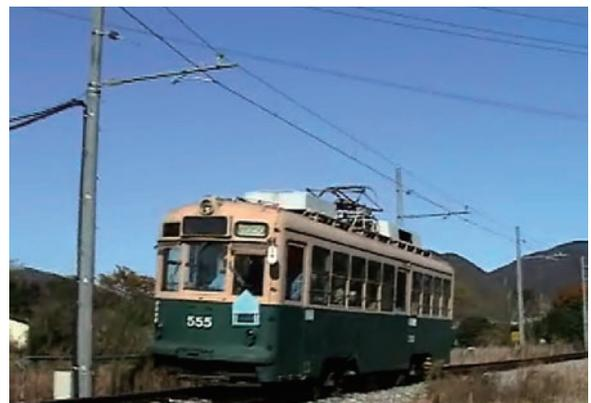
図5 LRT のバッテリー駆動走行試験の様子
