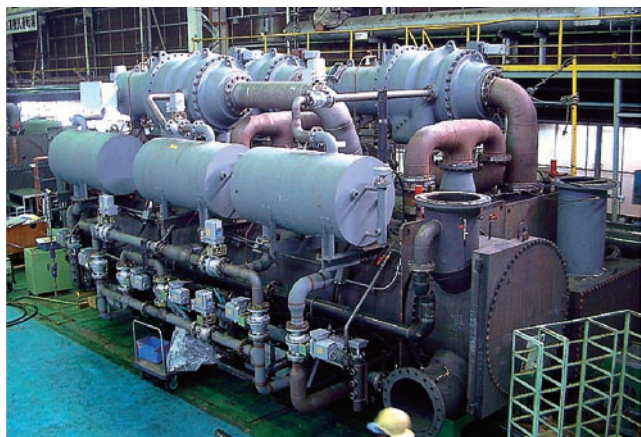
図6 10 MW コンパウンド型製氷ターボ冷凍機 10 MW コンパウンド型製氷ターボ冷凍機の外観（工場組立状況）を示す。
