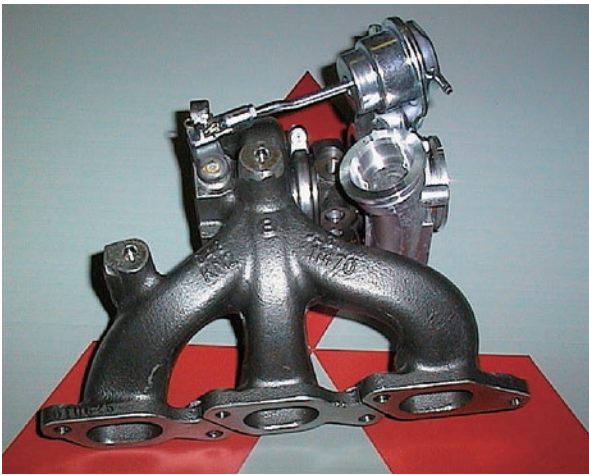
図 12 排気マニホルダー一体ターボチャージャー (一体鋳造)
