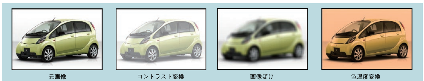
図2 基本外乱模擬部による外乱模擬の例
