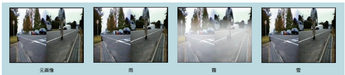
図4 天候外乱模擬部による外乱模擬の例
