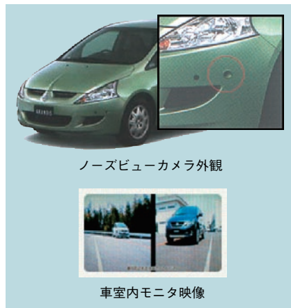
図5 車載ノーズビューカメラによる移動物体検出システム
