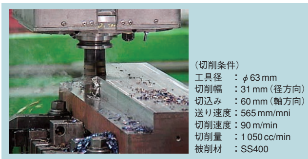
図5 エンドミル切削 ラム主軸のエンドミル加工とその条件.
