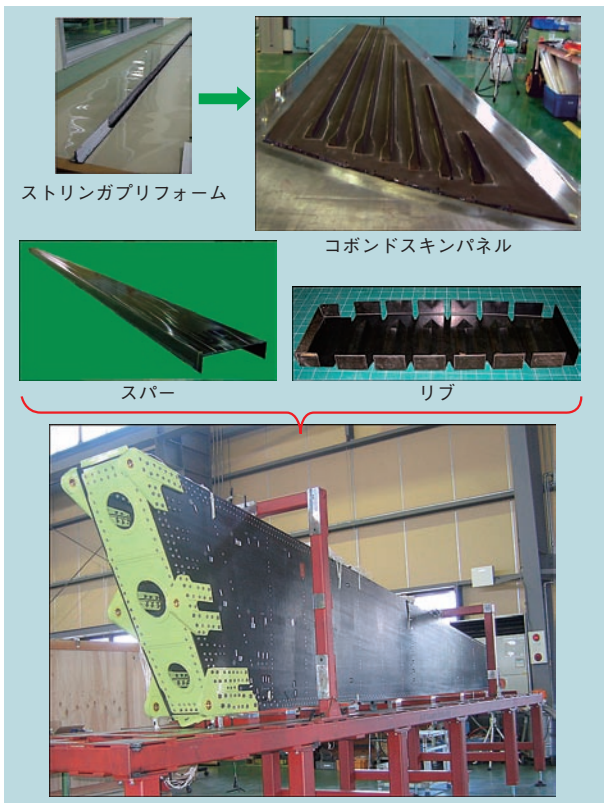
図5 実大垂直尾翼模擬供試体 効率的な製造法でも大きな問題なく実機相当品の製作ができた。
