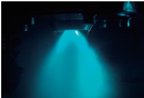
図11 燃料ノズル噴霧試験状況
