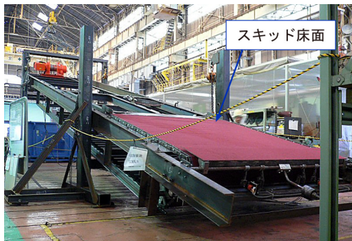
図3 基本構造を決定し、実機サイズの試験機を製作・検証
