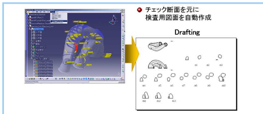
図3 検査用図面自動作成
