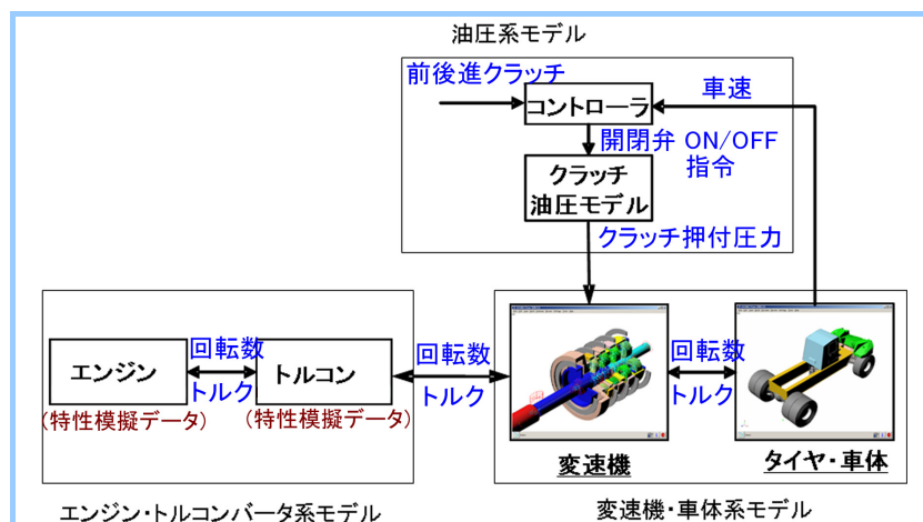
図3 変速時の揺れ現象再現モデルのモデル化範囲
