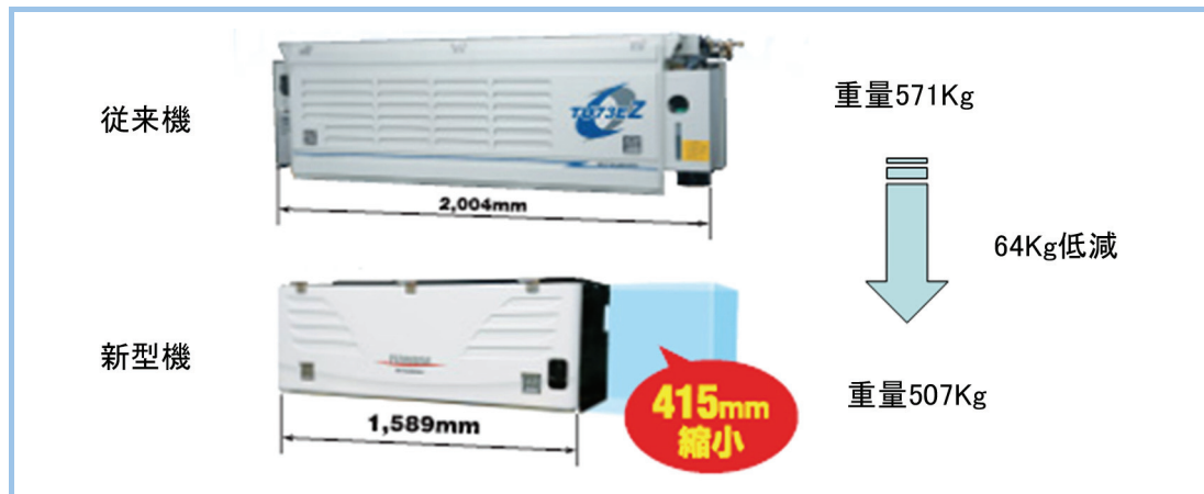
図2 大幅な小型軽量化を実現した新型機
