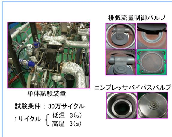
図8 単体試験装置及び作動耐久試験後の駆動部の写真
