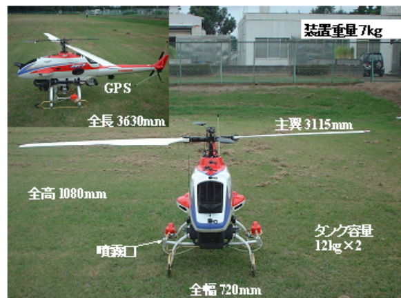
図2. 無人ヘリコプター (AYH-3) の全景を示す。左右の胴体にカセット式薬剤タンクが装着される。本実験では水を入れたタンクを用いた。図中の左上に示すヘリコプター後部のGPSによって姿勢制御が行われる。
