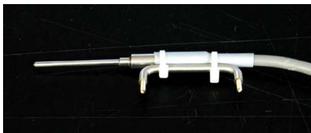
図 10. センサーを取っ手に固定
