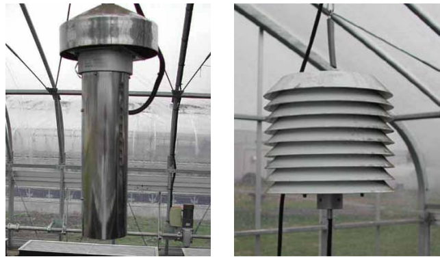
図 2. 強制通風式の放射よけ(左)と自然通気式の放射よけ(右)
