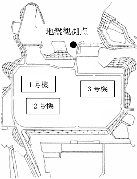
図-2 敷地地盤の地震計設置位置図
